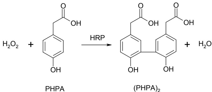
El método fluorimétrico para medir  $\text{H}_2\text{O}_2$  se basa en la medida de la fluorescencia del  $(\text{PHPA})_2$  formado luego de agregar  $\text{H}_2\text{O}_2$  y PHPA.
